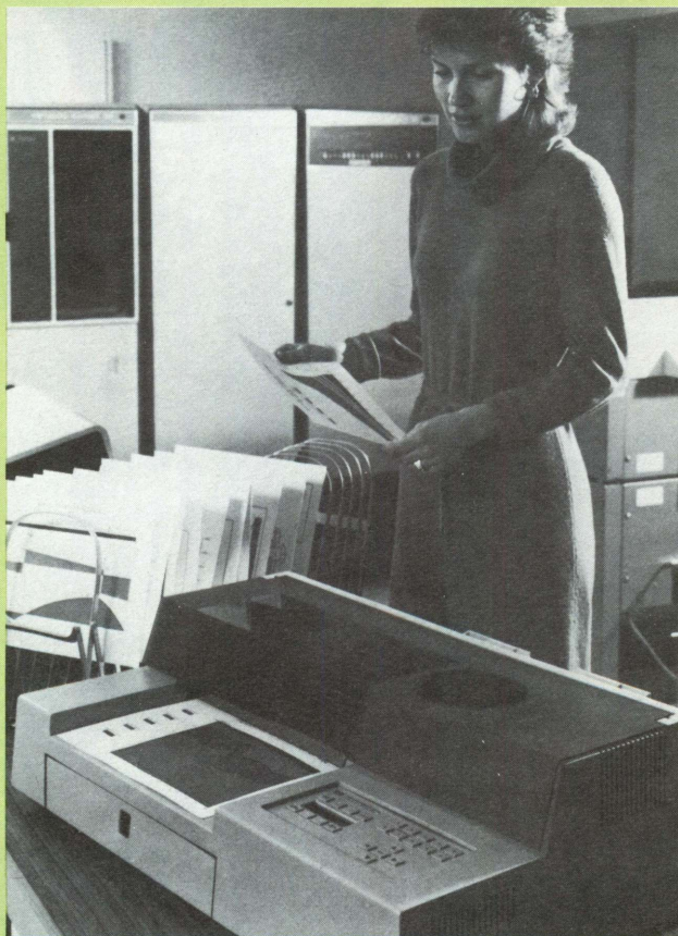
Il nuovo plotter HP 7550A. È in grado di riprodurre automaticamente 99 copie dello stesso grafico.
