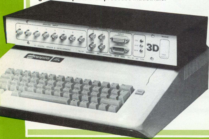
Un Apple //e con l'interfaccia 3D che gli permette di gestire una parte di un processo industriale.
